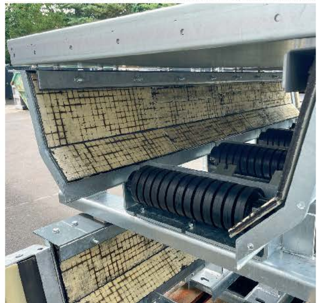
Tragrollen mit Puffering und Keramikauskleidung
