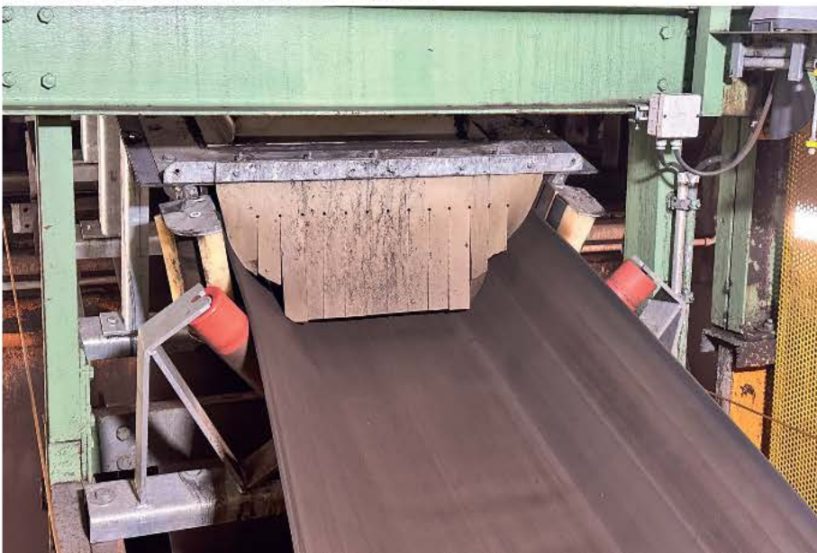
SafeLoad Einlaufbereich mit Gurtbreite 1.200 mm
